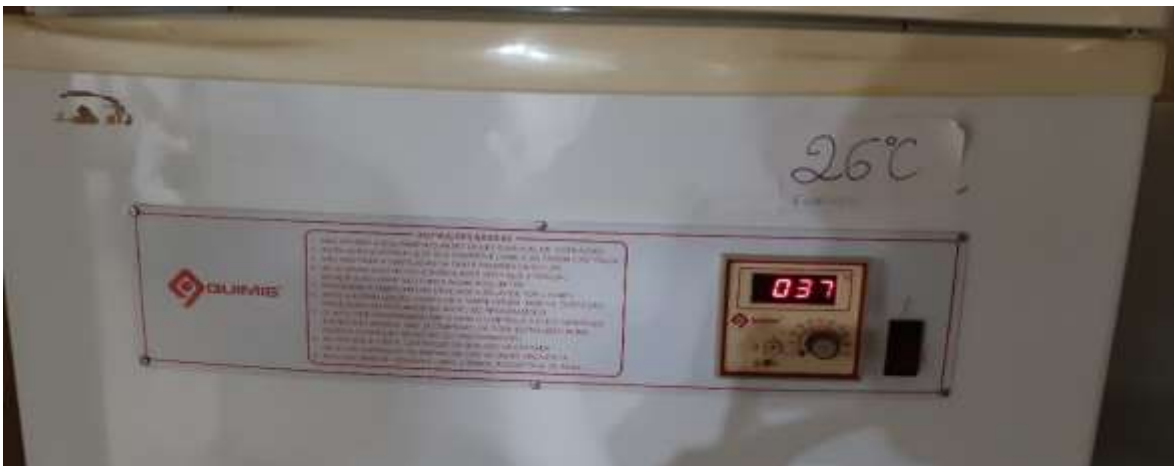
Figura 6. Estufa bacteriológica sob a temperatura de 37°C onde as culturas foram incubadas por 24 horas.
