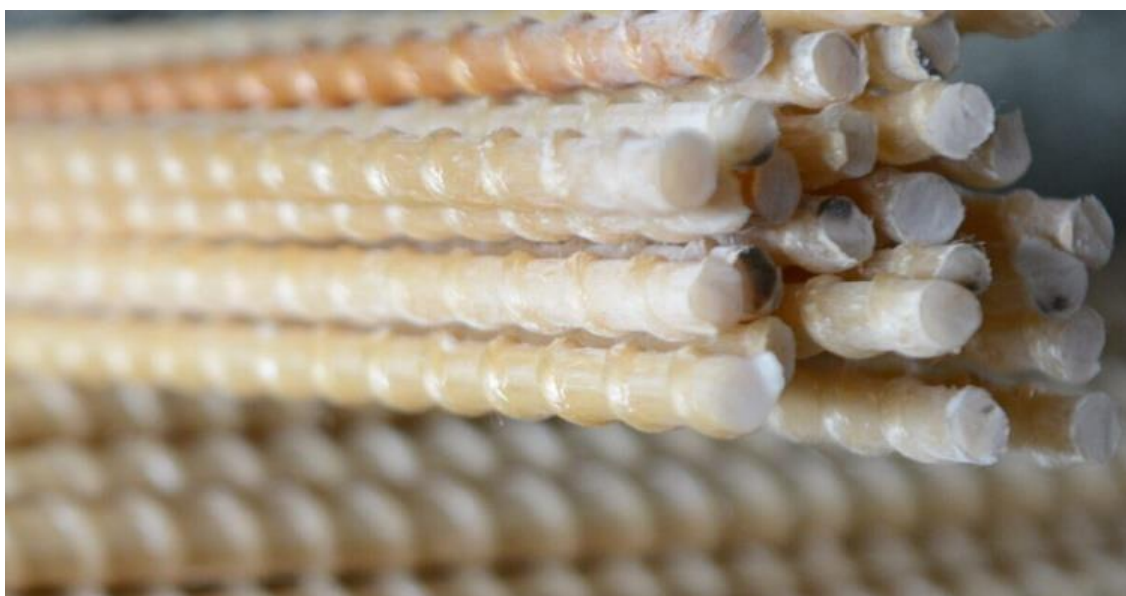
Figura 6: Vergalhão de polímero reforçado com fibra de vidro.
