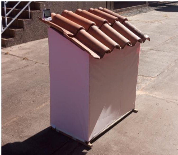
Figura 7. Ensaio com telha cerâmica. Fonte: Autores, 2024.
