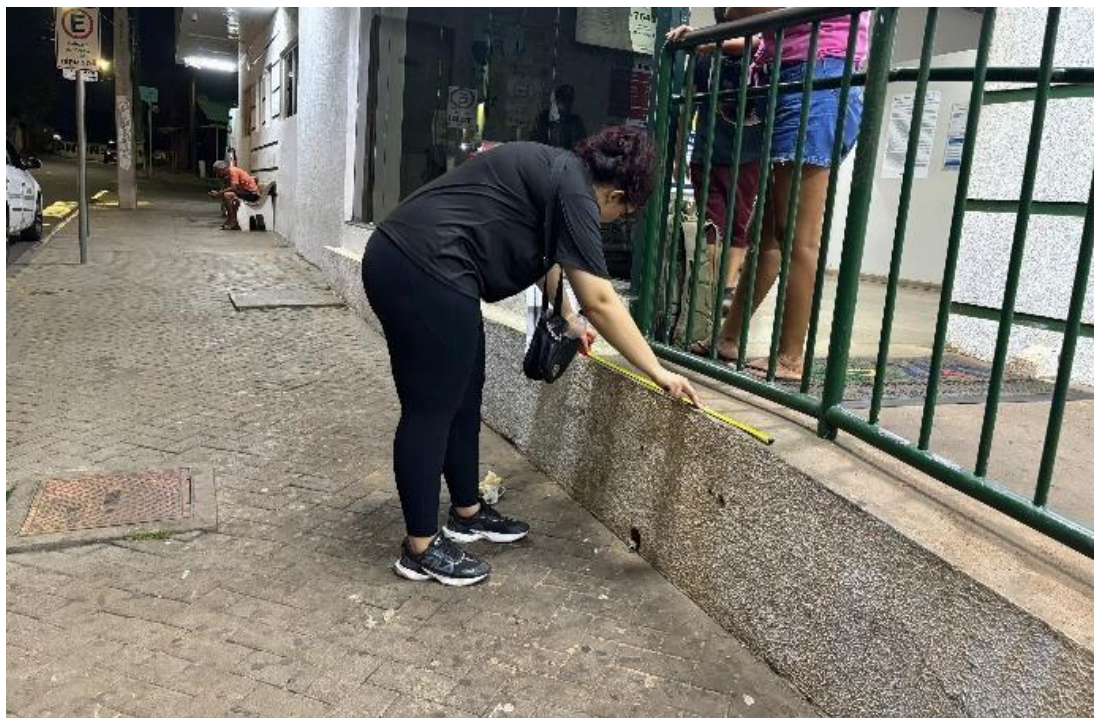
Figura 43. Conferência das medidas e inclinação das calçadas e rampas de acesso a UPA e a UBS Araguaína Sul. Imagem registrada em: 17 ago. 2024.
