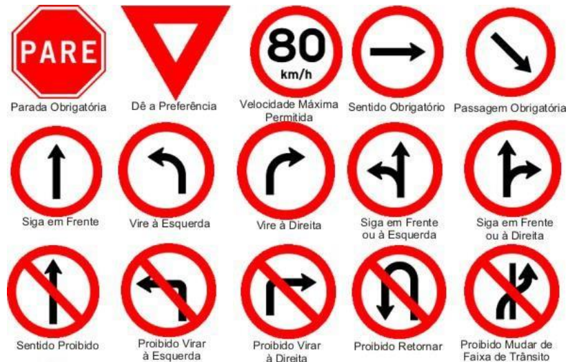
Figura 6. Sinalização vertical de regulamentação.
