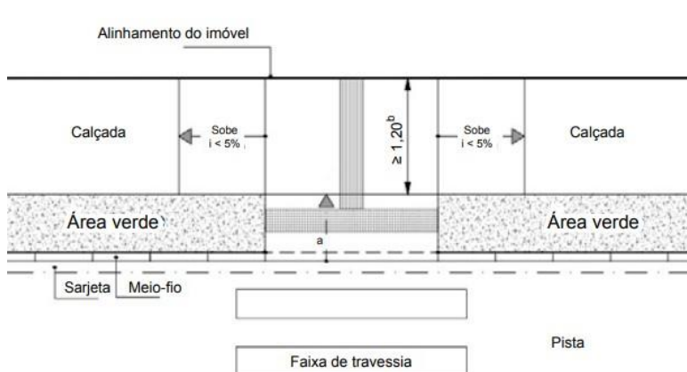
Figura 11. Rebaixamento da calçada entre canteiros.
