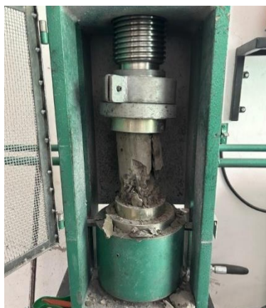
Figura 6: Rompimento de corpo de prova.
