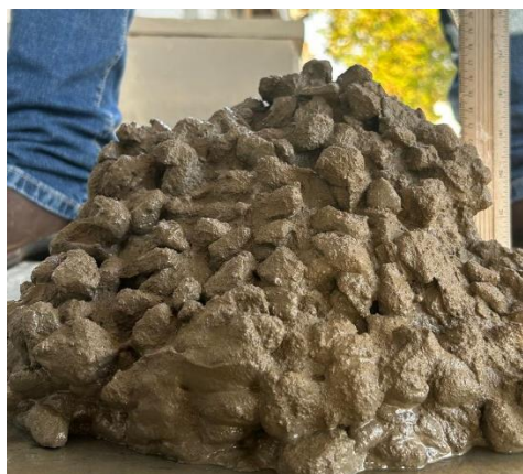
Figura 5: Slump test do concreto de referência.
