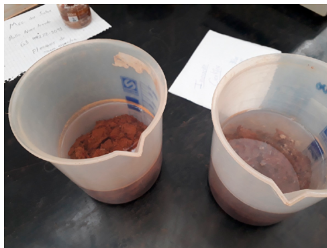
Figura 5. AM-01 após fraturamento por imersão parcial.
