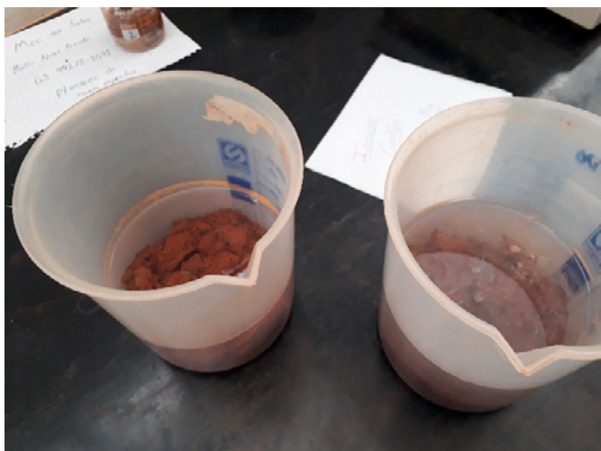
Figura 6. AM-01 sendo ensaiada por capilaridade.
