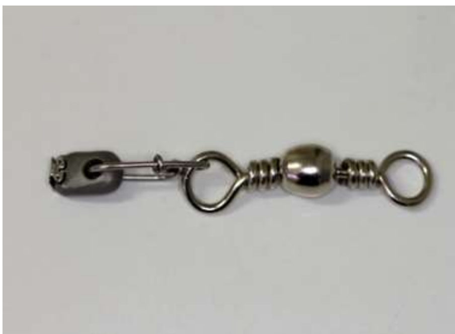
Figura 14. Acessório conector fundido em cromo-cobalto adaptado a um braquete e a um girador para minimizar os efeitos de rotação durante o ensaio de tração.
