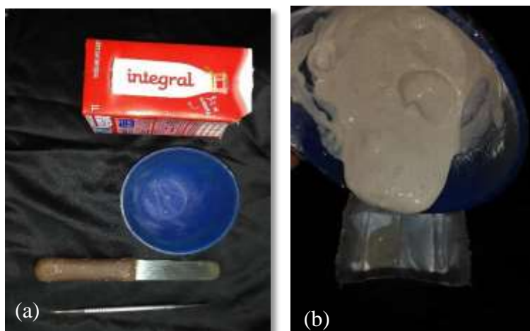
Figura 11. Técnica de confecção da matriz inicial do macromodelos: (a) caixa de leite vazia, cuba, Lecron e espátula para gesso; (b) manipulação do gesso;
