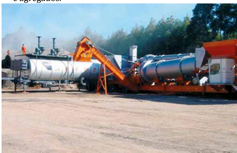
Figura 4: Usina de asfalto utilizada na mistura do ligante e agregados.
