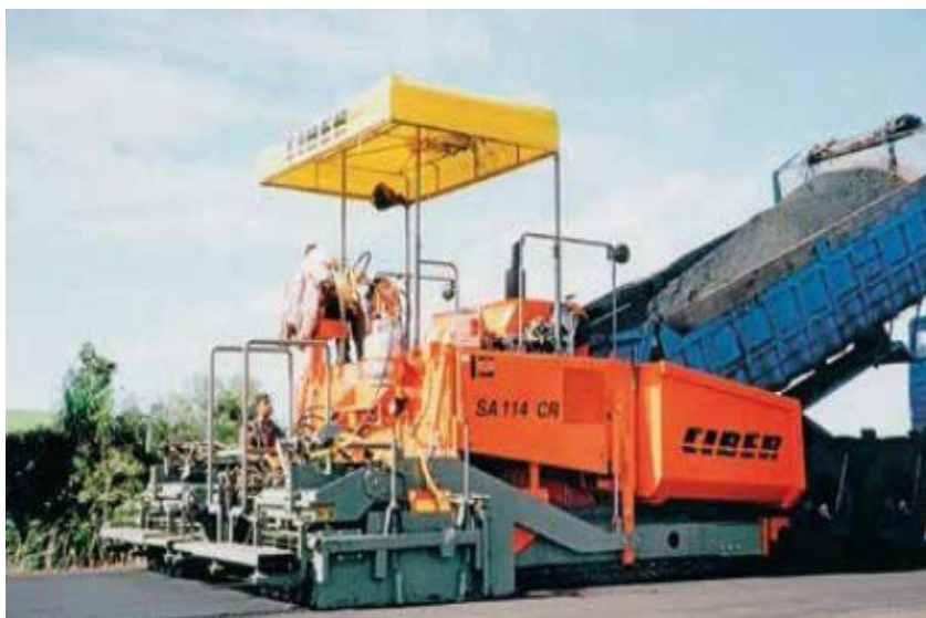
Figura 9: Distribuição do material na pista com a pavimentadora automotriz.
