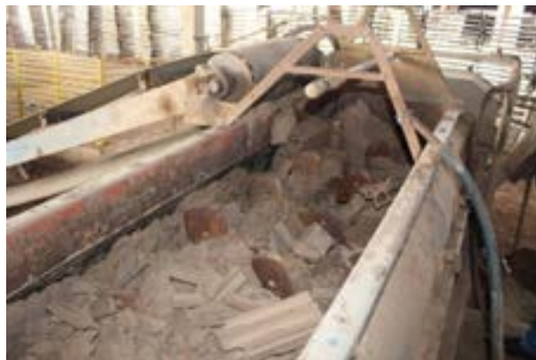
Figura 12. Misturador (adição de água a argila).
