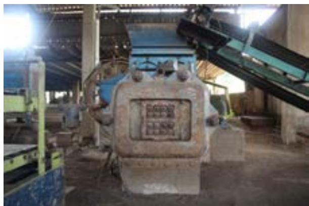
Figura 13. Fôrmas dos blocos de 8 furos.
