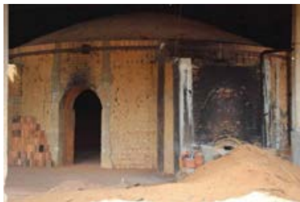
Figura 16. Forno refratário para queima da peça cerâmica (Temperaturas de até 600 °C).
