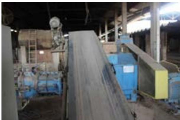
Figura 11. Esteira de transporte do misturador para a Extrusora.
