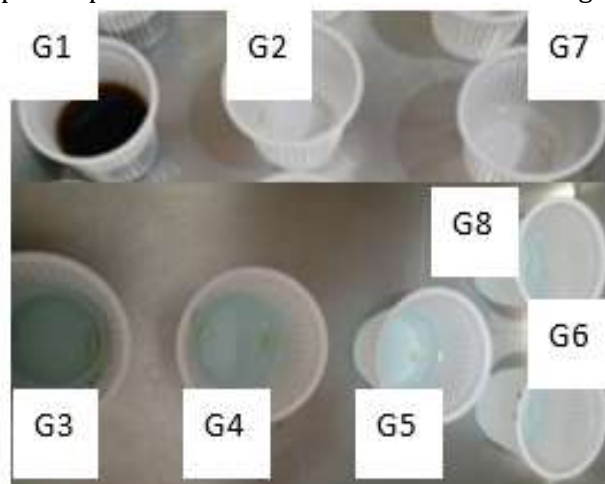
Figura 3: Corpos de prova imersos nas substâncias de cada grupo do estudo.
