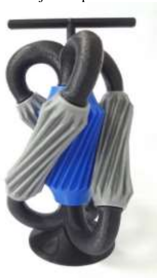
Figura 2. Objeto impresso em FDM.
