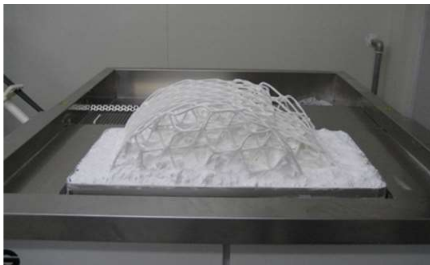
Figura 5. Objeto impresso em SLS.
